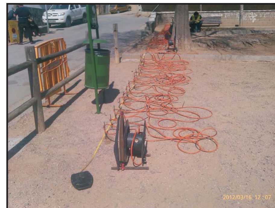
Perfil de tomografia elèctrica PTE-4B.
