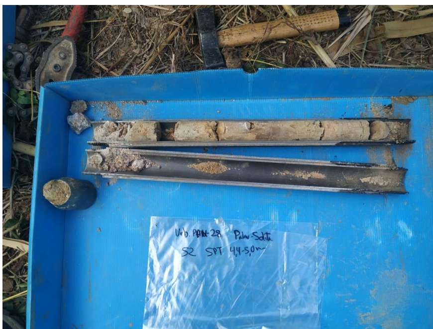
Assaig SPT de -4,4 a -5,0 metres de profunditat en sondeig (S2).
