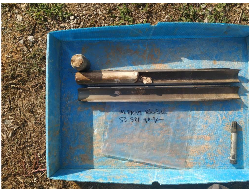
Assaig SPT de -4,0 a -4,6 metres de profunditat en sondeig (S3).
