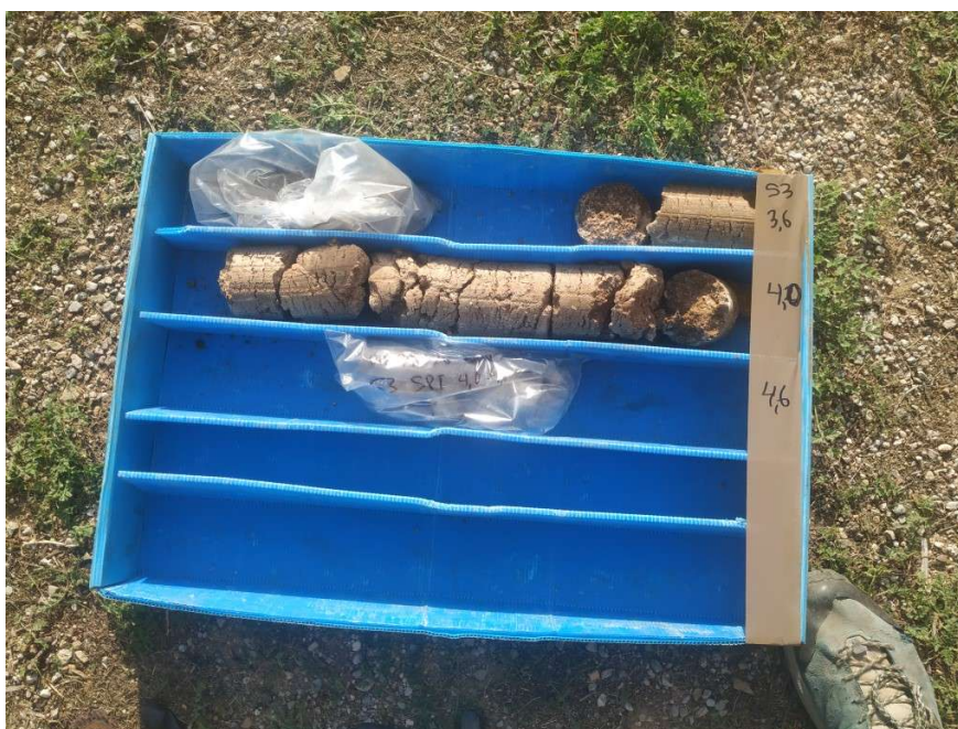
Caixa portamostres de -3,0 a -4,6 metres de profunditat en sondeig (S3).
