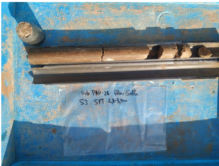
Assaig SPT de -2,8 a -3,4 metres de profunditat en sondeig (S3).
