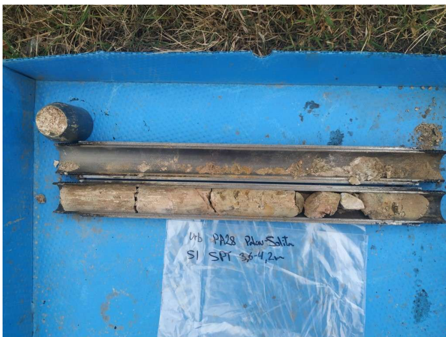
Assaig SPT de -3,6 a -4,2 metres de profunditat en sondeig (S1).
