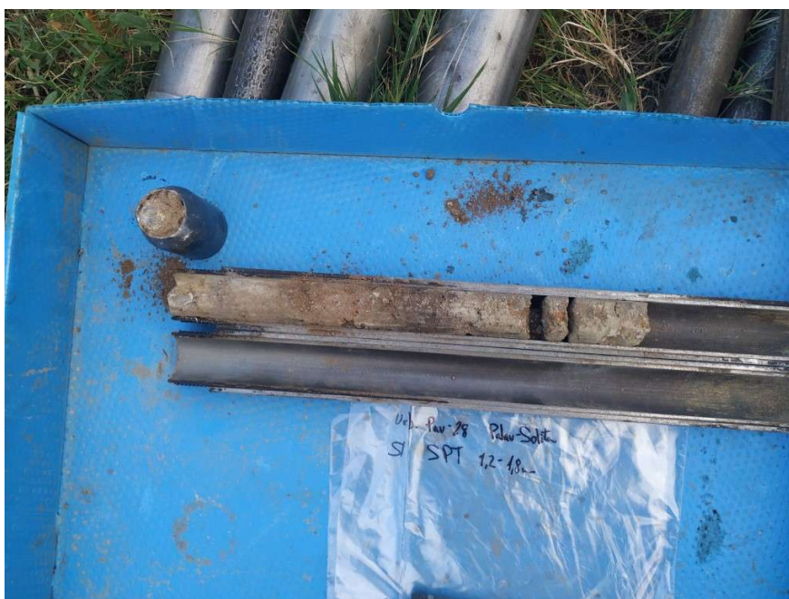
Assaig SPT de -1,2 a -1,8 metres de profunditat en sondeig (S1).
