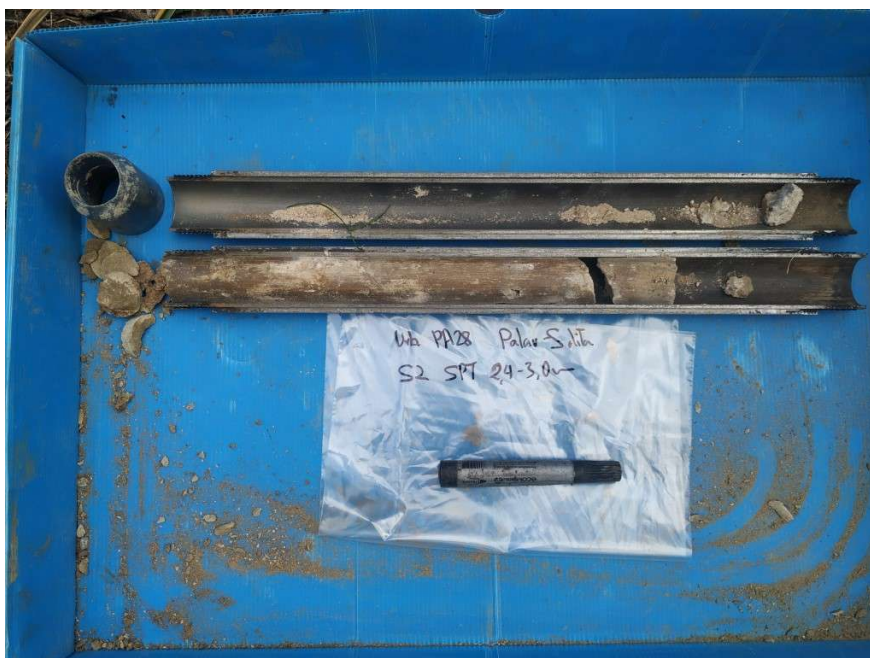
Assaig SPT de -2,4 a -3,0 metres de profunditat en sondeig (S2).
