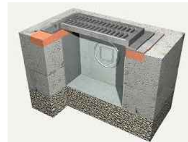
Detall embornal de formigó
