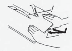
Sierra mal protegida. Mala posición de las manos.
