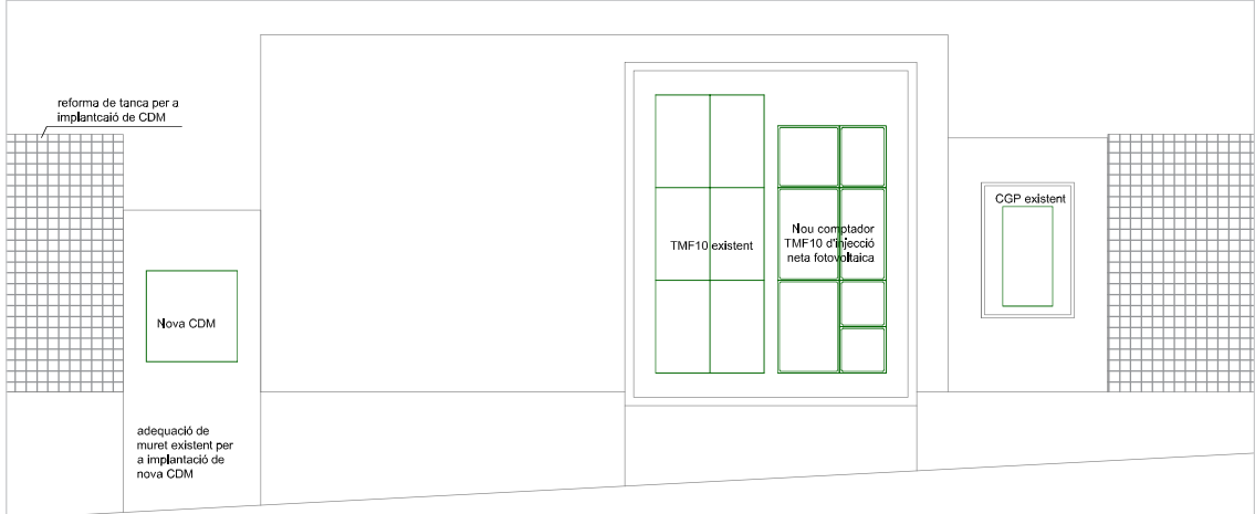
Estat final. Alçat armari comptadors. Escala: 1/25
