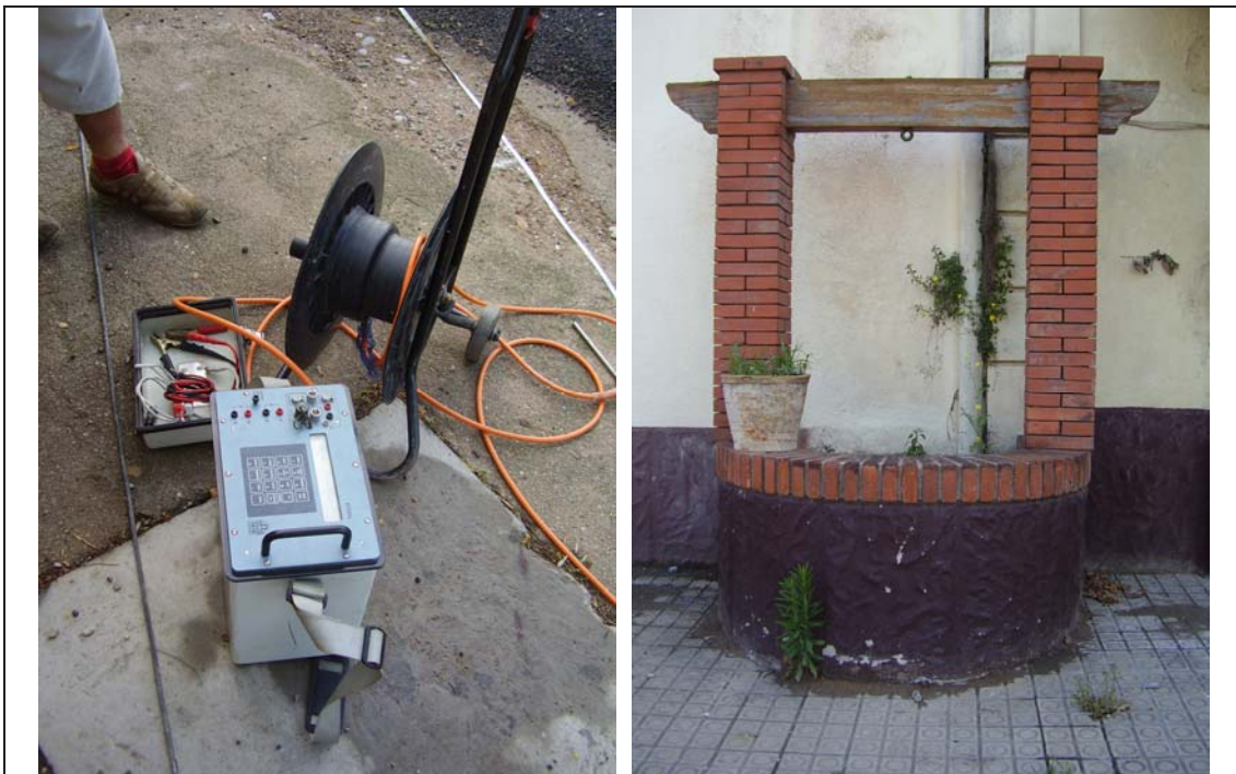
Fotografia 10. Foto de l'esquerre els aparells de tomografia elèctrica. Foto de la dreta detall del pou d'aigua situat davant la façana del cobert de Can Periquet amb el nivell d'aigua a -3.20m de la superfície
