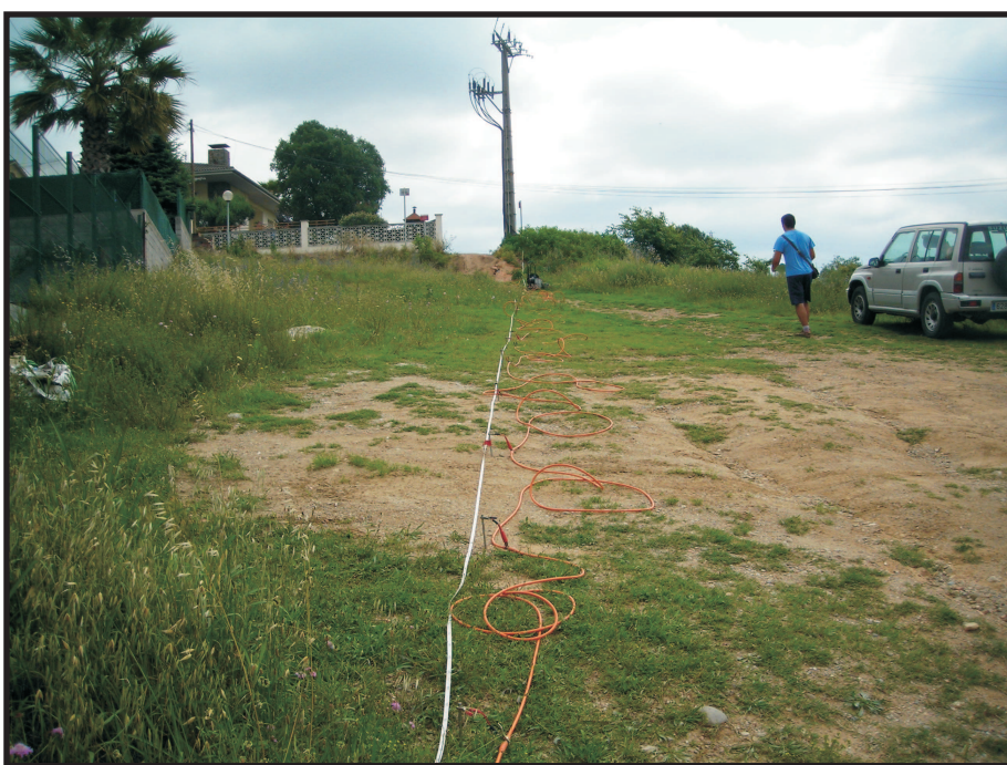
Perfil de tomografía eléctrica PTE-2.
