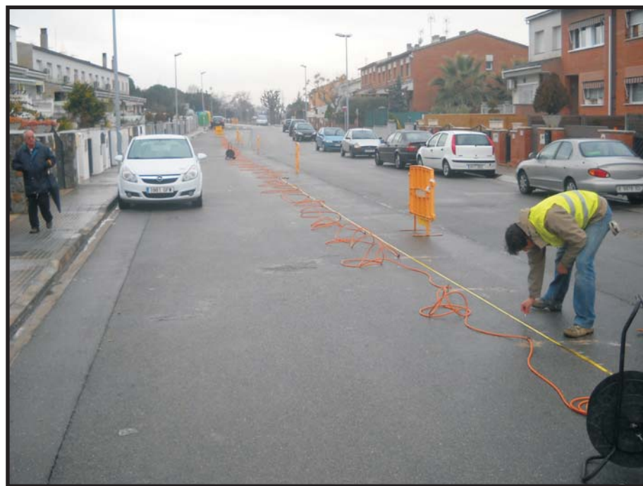
Perfil de tomografía eléctrica PTE-2A .
