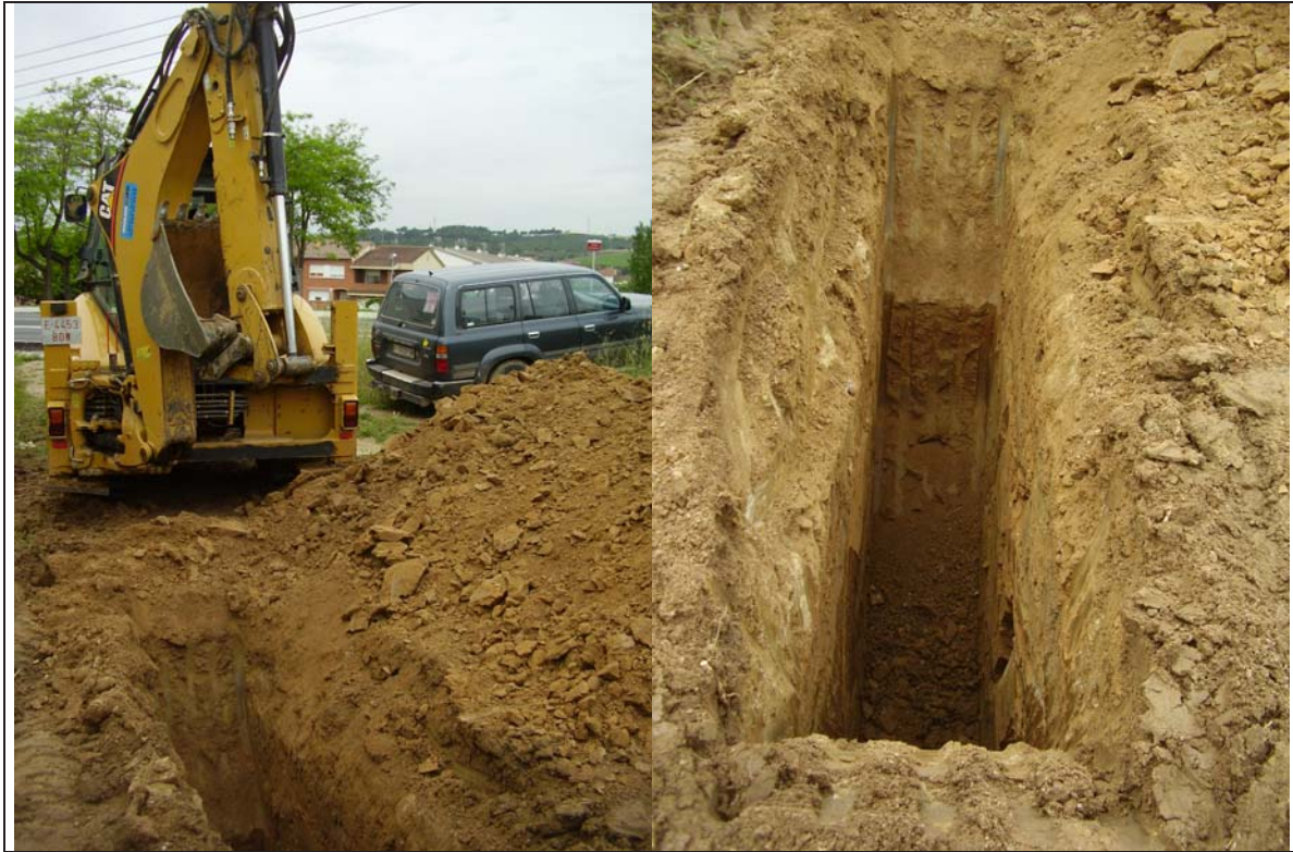
Fotografia 7. Detall de la calicata C7: màquina treballant, testimoni del forat i del material extret.
