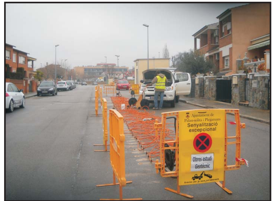
Perfil de tomografía eléctrica PTE-2B .
