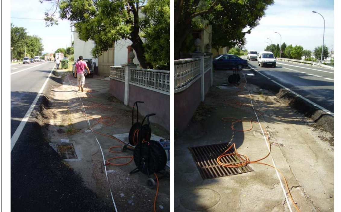
Fotografia 9. Realització de la tomografia elèctrica perfil N°3, foto de la esquerre s'observa e traçat cap a Nord, i la foto de la dreta s'observa el traçat cap a Sud.
