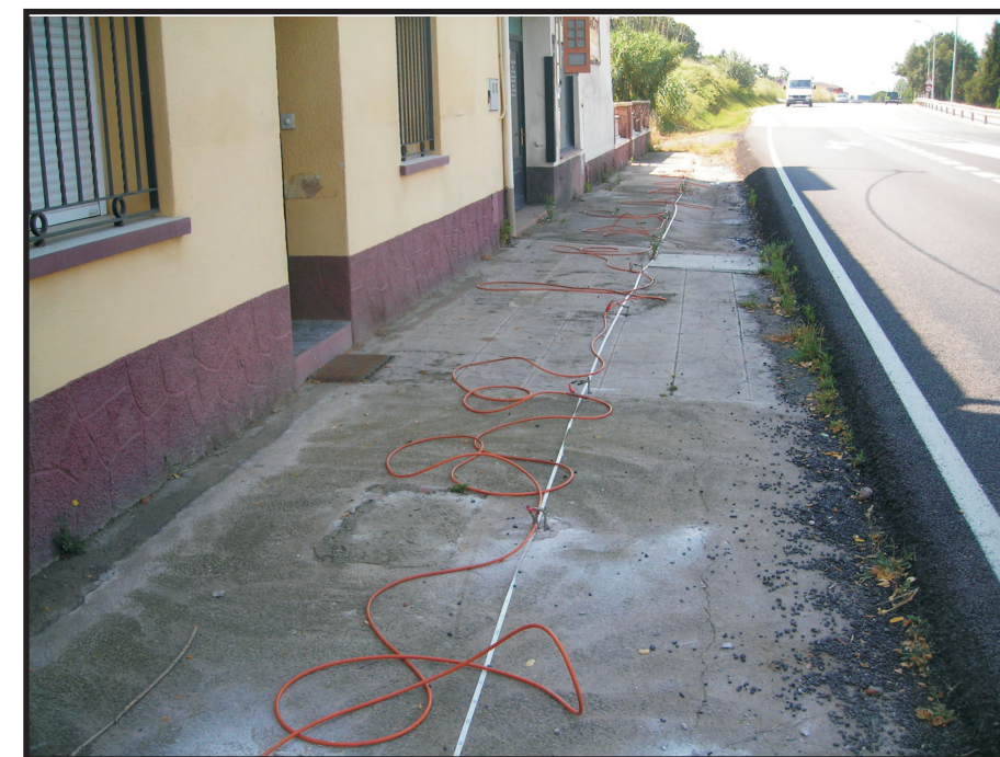
Perfil de tomografía eléctrica PTE-3
