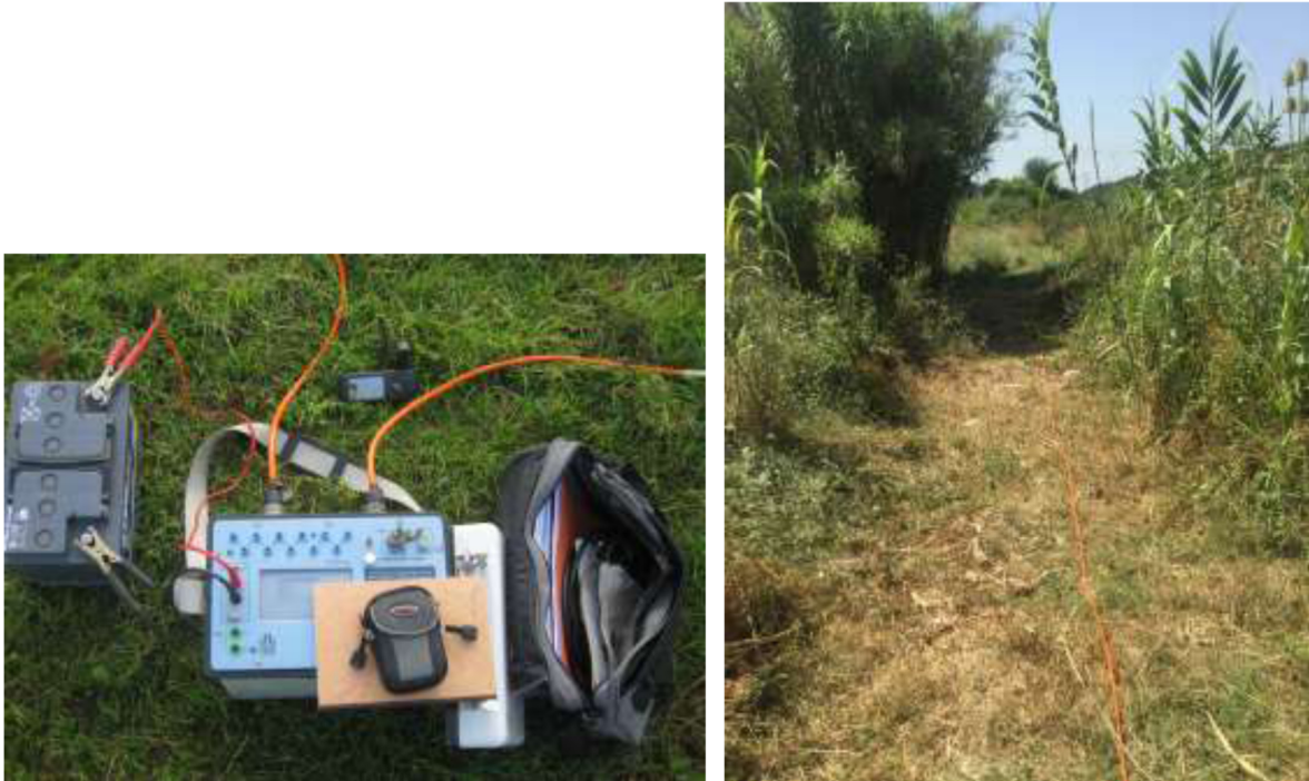
Figura 4. Resistímetre Syscal Pro (esquerra) i cable d'elèctrica estès al llarg d'un perfil (dreta).
